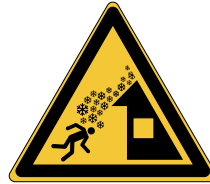
Roof avalanche W040
