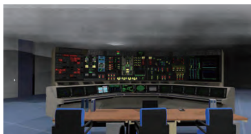
VRで模擬した中操 (上:初期状態、下:火災状況(煙層 床上約2.9m))
