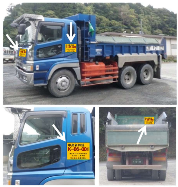
標識のダンプ明示状況
