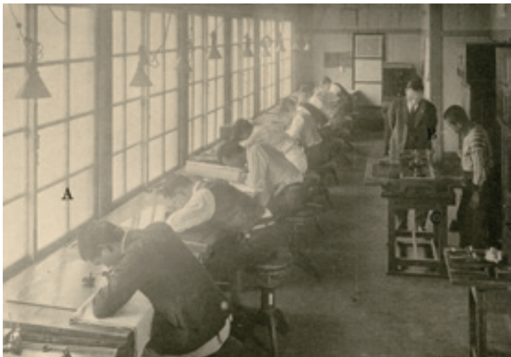
【図6】 銅版彫刻作業（『陸地測量部写真帖』、当館所蔵）
