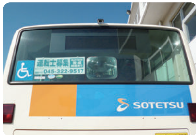
バックアイカメラを設置した車両
