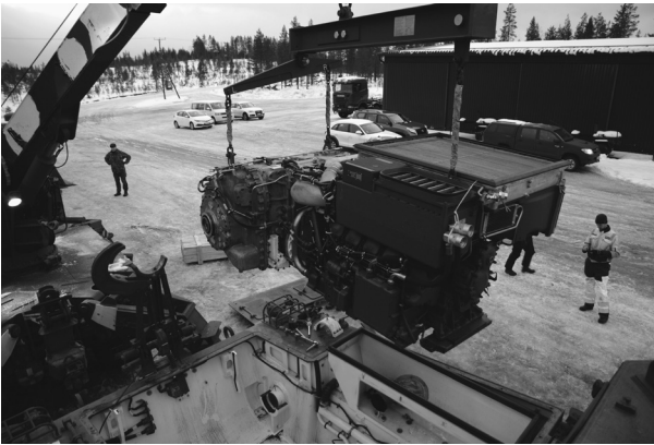
Kuva 2. K9-voimapaketin irrottaminen kenttäolosuhteissa.
