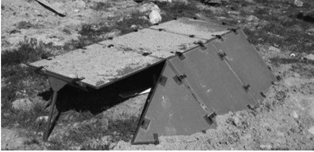
Kuva 1. Sirpalesuojapaneeleista rakennettu henkilösuoja.
