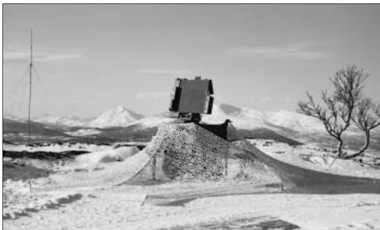
Maalinosoitututka AN/MPQ-64 on operatiivisessa käytössä Norjassa ja testattu myös talviolosuhteissa. Kuva: Kongsberg Defence & Aerospace AS.
