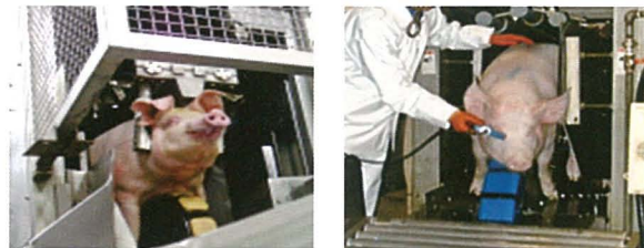
図13 自動（左）と手動（右）電撃装置
