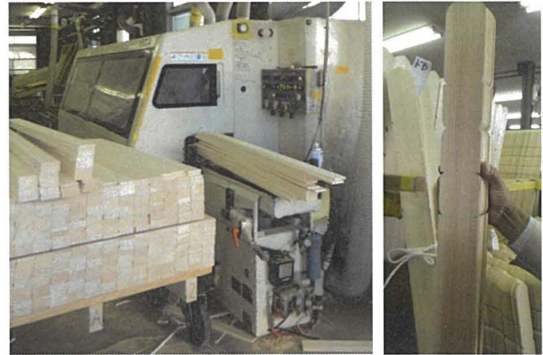
写真-1 卒塔婆生産の様子 （左：山板とモルダー、右：卒塔婆完成品（2015/10/13 小杉撮影））
