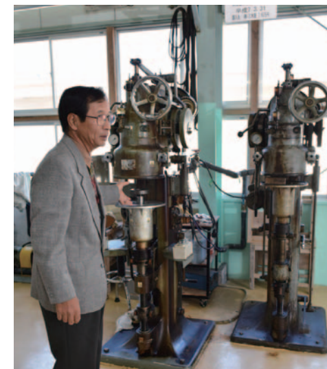
※バキュームシーマー / 真空巻締機で缶の脱気と密封を同時に行う機械。
