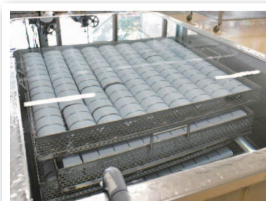
⑧冷却槽で充分冷却する。
