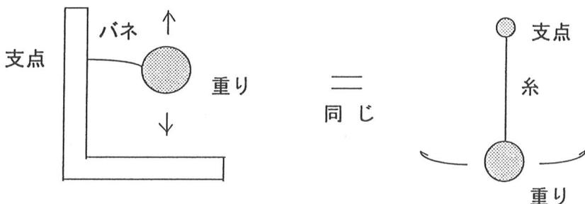
地震計は、重りが支点にバネでつながった振り子を利用していますが、重りを糸で垂らしただけのもっと身近な振り子を使えば、実際に手にとって実験できます。どちらも振り子は振り子です。振り子の理論は、実際の構造がどうあろうと、振り子であれば適用しますからかまいません。理論のいいところです。
