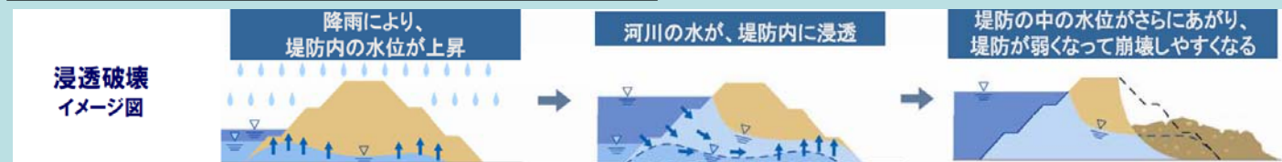
H24.7九州北部豪雨による堤防決壊と浸透破壊のメカニズム
