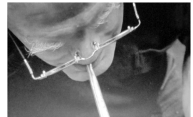
図2 ブローパイプの使用法 （スミソニアン、ターナー博士より）
