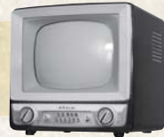
1957年 / TB-50 押しボタン式チャンネル切替装置で、 押すだけで素早く選局ができる
