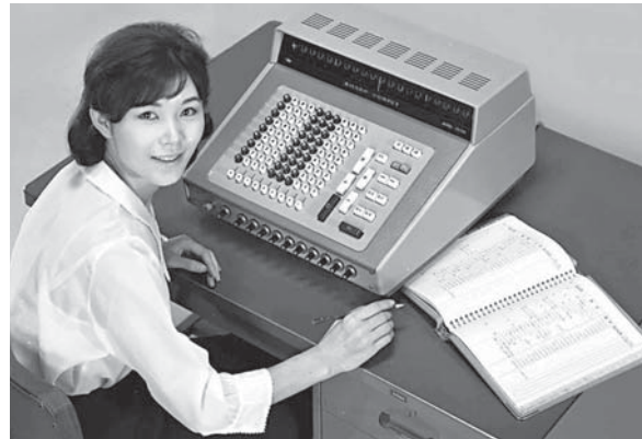
世界初のオールトランジスタ電子式卓上計算機「コンペット」<CS-10A>
