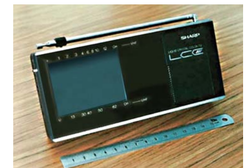
試作された3.2型TFT液晶カラーテレビ(1985年)
