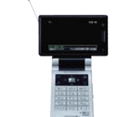
ディスプレイが回転するワンセグ放送対応携帯電話(ボータフォン向け)
