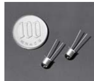
近赤外光と可視光を同時に放射する、ダブル発光ダイオード
