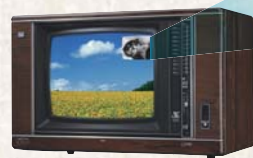
1978年 / CT-1804X 裏番組も、同じ画面の中で同時に映る 「テレビ・イン・テレビ」
