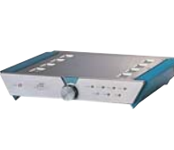
世界初、2.8MHzの高速サンプリング/7次デルタシグマ変調方式の、1ビットアンプ
