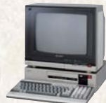
1982年 / CZ-800C/D テレビ受像とパソコン機能に加え、 両方の画像の重ね合わせができる
