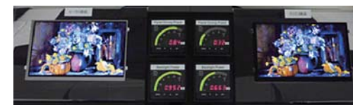
従来品と比べて低消費電力を実現したIGZO液晶(右)
