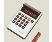
世界初、液晶表示ボケアップ電卓「液晶コンペット」
