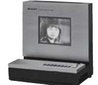
高輝度・長寿命の薄膜EL素子でテレビ映像再生に成功(写真は1977年のもの)
