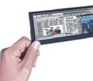
バックライト不要、明るい屋外でも鮮やかなカラー表示ができる高反射型液晶(スーパーモバイル液晶)
