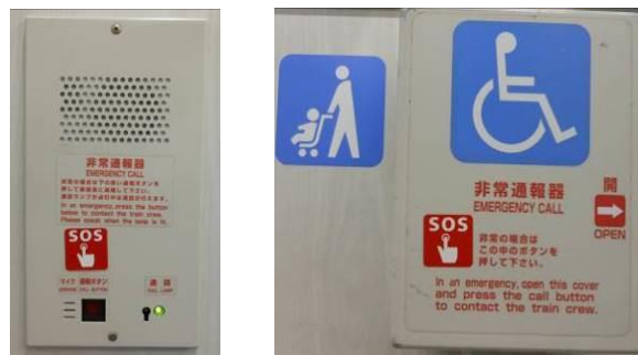
〈非常警報装置〉
