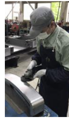
仕上げ研磨 (手作業)
