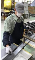
スポット溶接 (手作業)
