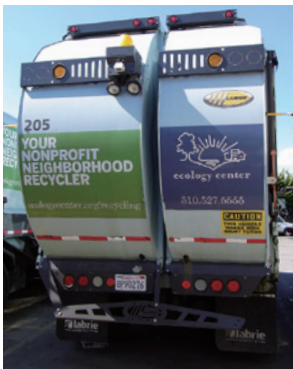
米国：収集車には投入口が2つあり、紙類と他の資源物を分けて回収する。
