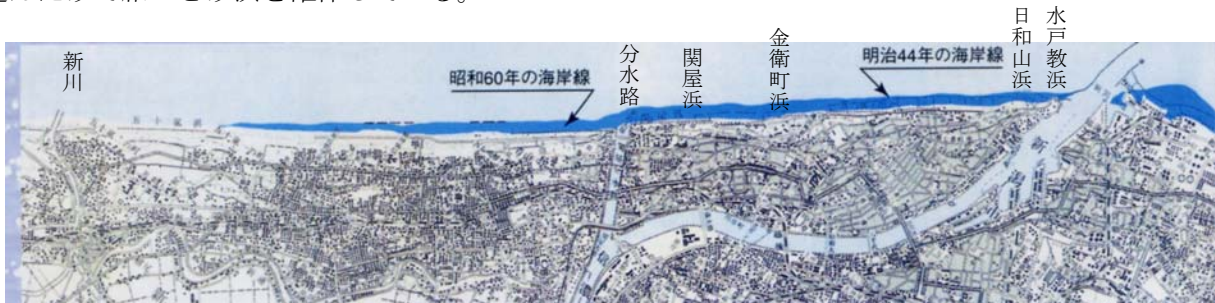
図-2 明治 44 年と比較した新潟海岸の汀線変遷の図(昭和 60 年) この後も侵食は進み砂浜は消滅。
