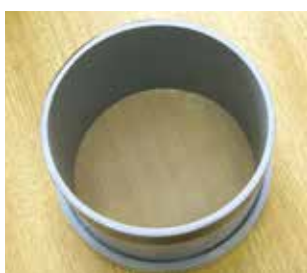
塩ビ管+メッシュ+ソケットが基本ユニット。管の呼び径は10cm、高さは8cm。
