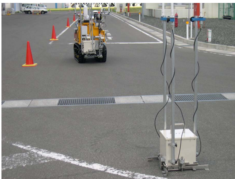
無線中継機を設置しながら、活動現場へ自走するモニロボB
