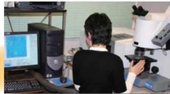
ステップスキャン型 イメージング FT-IR 分光器
