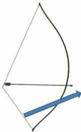
下が短いので同じ距離だけ弦を引けば、下から上に押し出す力が強い。 →矢は上に飛び出す。
