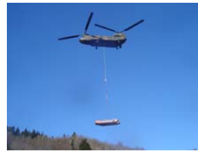
河道閉塞湛水箇所の台船引き船運搬状況
