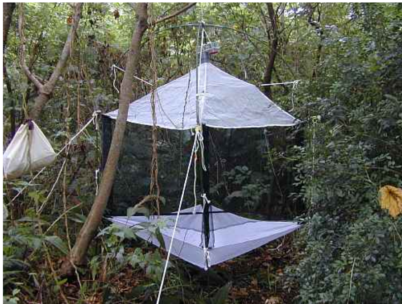
図Ⅱ.3.15 コウモリの餌資源量を把握するための餌昆虫トラップの例
