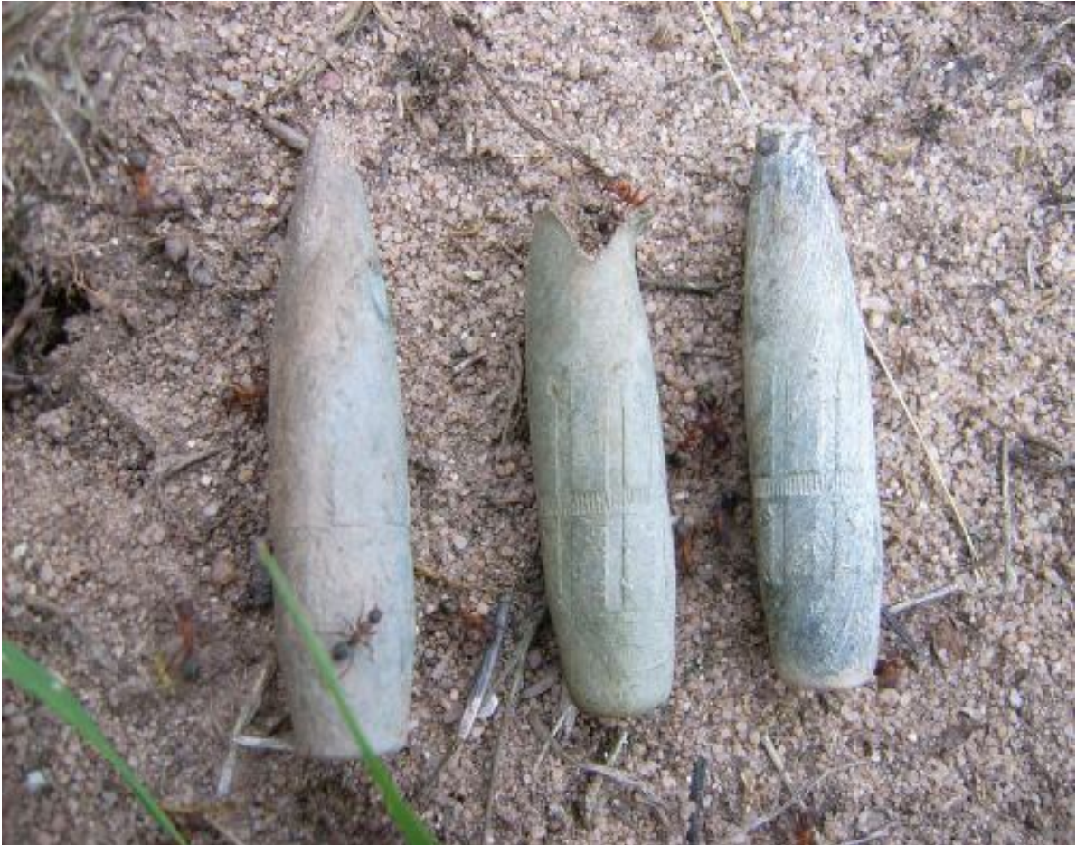
Kaliber . 50 Projektile. Diese aufgefundenen Geschosse weisen zum Teil Deformationen auf, die beim Einschlag entstanden sind. Auch gut zu sehen die Züge und Felder des Laufs, die sich beim Abschuss in die Oberfläche der Projektile eingekerbt haben.
