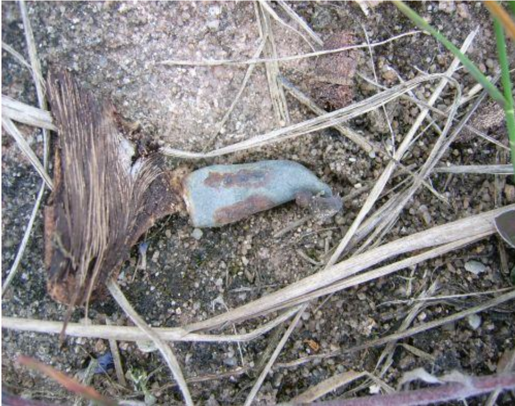
Deformiertes Projektil im Kaliber 7,62 x 51 mm, aufgefunden im Bereich einer Schießbahn. Verschossen wird diese Munition aus Koaxial neben der Kanone von Kampfpanzern angebrachten Maschinengewehren oder durch Infanterie mit MG's auf Zwei- oder Dreibein sowie Lafette auf Fahrzeugen.
