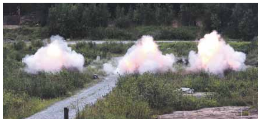
Kolme viuhkapanosta räjähtää ampuen 2 m korkean sirpaleviuhkan eteensä. Yksi viuhkapanos sisältää 924 sirpaletta.
