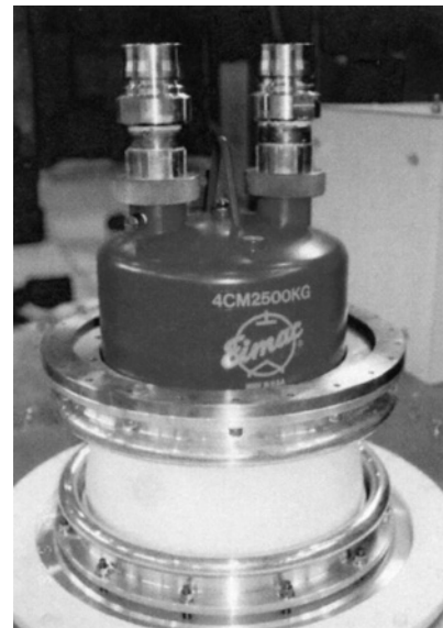
Fig. 4 大電力四極真空管(米国CPI社)。世界のICRF加熱装置の多くで使用されている。最大出力約2 MW(実用周波数130 MHz以下)。
