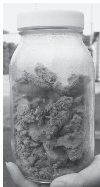
図3 脱水後の下水汚泥 (臭い成分の除去により、灰色に脱色されている)
