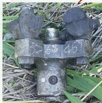
補機駆動軸CGカップリンク (19.0kg)
