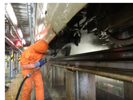
函館新幹線総合車両所での車両融雪作業
