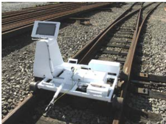
分岐器検査装置(株式会社カネコ ホームページより)
