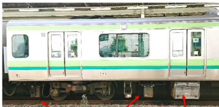
軌道変位モニタリング装置 軌道材料モニタリング装置
