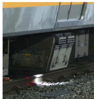
測定状況 (軌道材料モニタリング装置)
