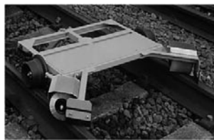
取り組みの例： 軌道自転車用降灰除去装置の開発
