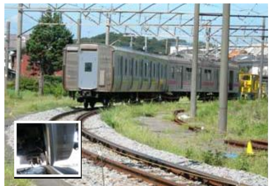
乗り上がり脱線走行試験の状況
