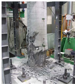
補強しない場合の損傷状況
