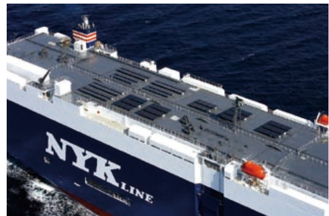
太陽光エネルギーを活用した自動車専用船 (写真提供: 日本郵船)
