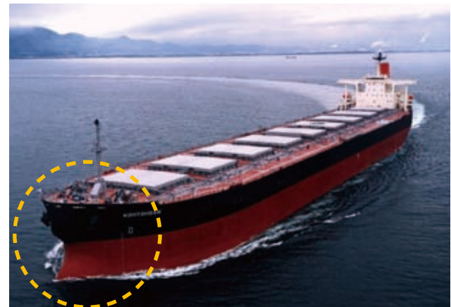
Ax-Bowを採用したばら積み貨物船 (写真提供: ユニバーサル造船)
