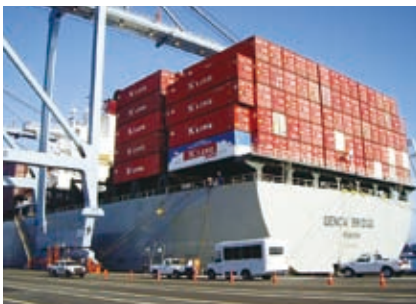
陸上電源供給中のコンテナ船
