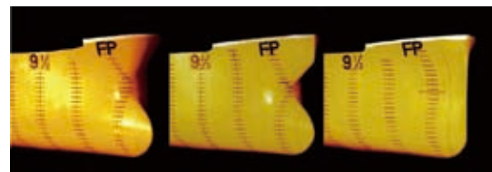
船首形状の改良 (左: 従来型船首、中: Ax-Bow、右: LEADGE-Bow) (写真提供: ユニバーサル造船)
