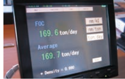
燃費効率を表示する「FUELNAVI」 (写真提供：日本郵船)
