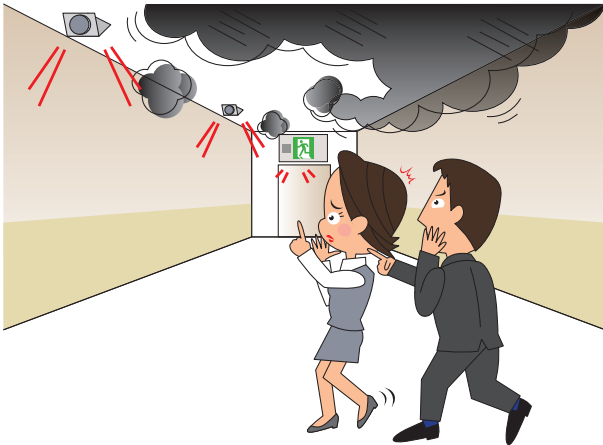
図7 先行音(ハース効果)による避難誘導システムの概略図 Fig. 7 Directional sound escape guidance system using the Haas effect
