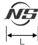
型式適合評価合格の表示 (刻印) (大きさ:L=12mm)
