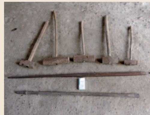
写真3 石積み作業に使用されたゲンノウ(上)とカナテコ(下)
