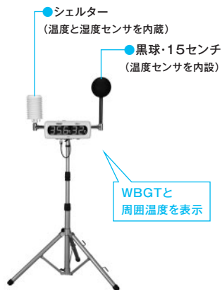
図3 WBGT測定装置 (リアルタイムでWBGTと周囲温度が表示される)
