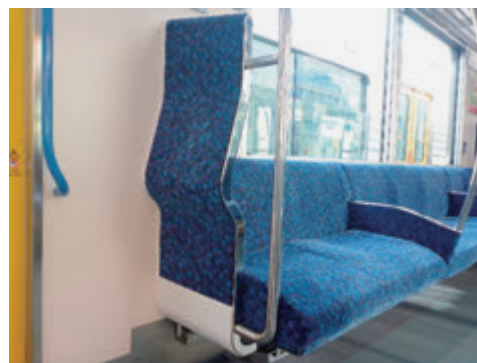
写真-4① 大型袖仕切
