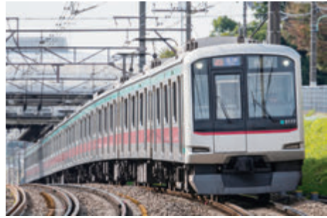
E231系をベースに製作された東急5000系電車（2代目）。仕様をJRと共通化することで3割程度のコストダウンを実現しました。
