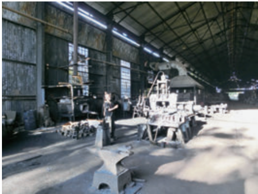
写真-5 ナイロビ駅の南側にある車両修理施設の内部。車両の修理設備も近代化の必要がある。(2014年11月14日)
