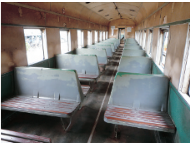
写真-10 マプト駅に停車している客車の内部。ボックスシート(横に2+3席配置)の座面は木製である。内部も相当いたんでいる。(2012年12月6日)
