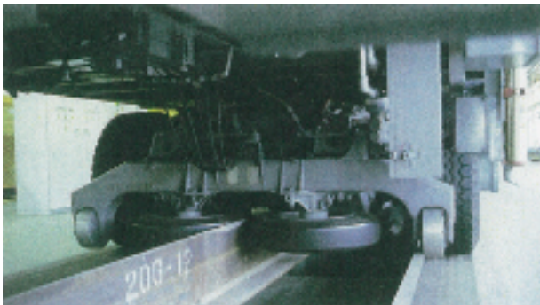
資料-2 中央案内軌条とゴムタイヤ 鉄輪に比べ、加速・減速性能に優れている
