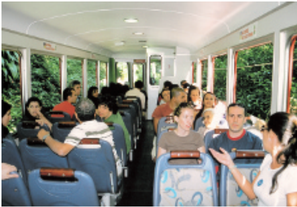
写真-9 登山電車の車内は、座席が横に2+3席配置、窓は開放式である。(下りの電車内で山頂駅方向を見る。2008年6月29日)
