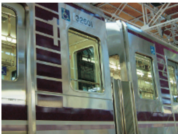
(写真3) 外板号車表示
