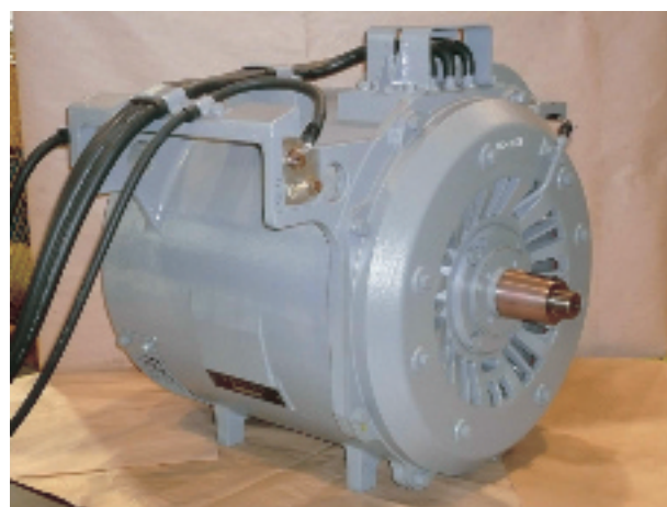
(写真10) 主電動機本体
