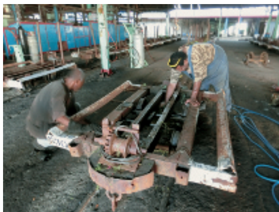
写真-37 FSCラウトカ工場内のサトウキビ貨車修理所では、作業員2人が修理をしていた。(2014年2月24日)
