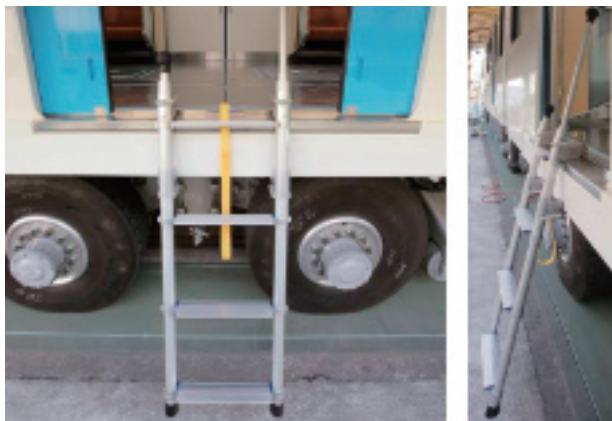
写真-6 客室内の非常梯子
