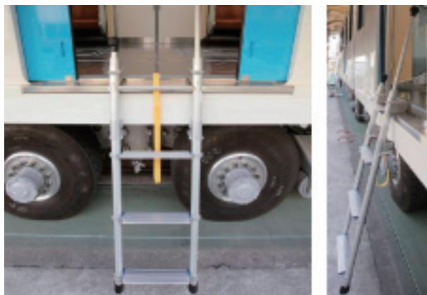
客室内の非常梯子
