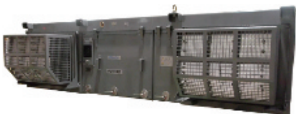
写真-6 1300系 VVVF 制御装置
