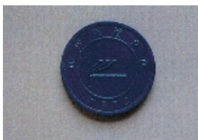
直径3cmのICトークン。入場時は改札機にタッチし、出場時は改札機投入口に入れて回収される。
