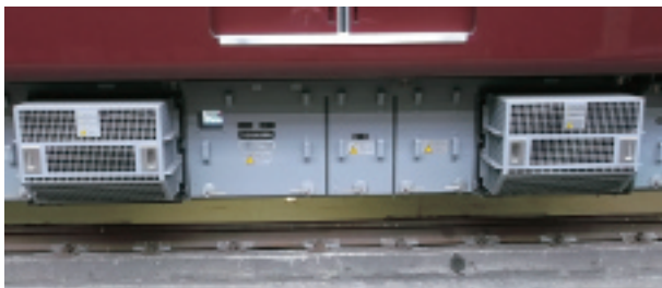
写真-5 1000系 VVVF 制御装置
