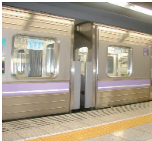
連結部転落防止外ホロの整備
