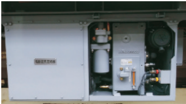
写真-9 電動空気圧縮機
