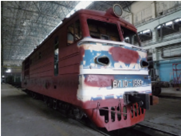
写真-25 トビリシ電気機関車工場で再塗装されるアルメニア鉄道の電気機関車 (VL10)。(2009年11月9日)
