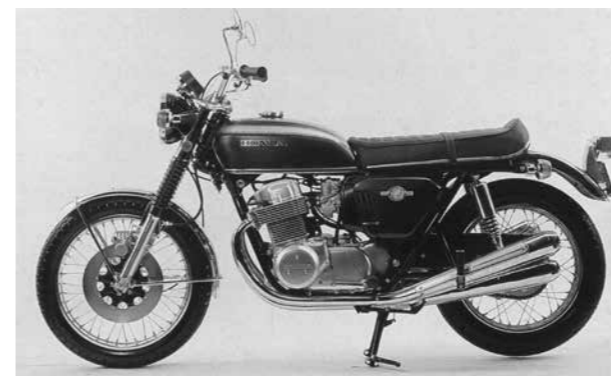
ホンダCB750プロトタイプ。開発責任者の原田義郎氏によれば、前輪のディスクブレーキは本田宗一郎社長(当時)の即断で採用されたという。
