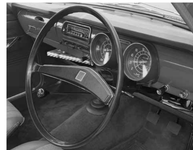
視覚的に+αの要素が一番感じられたのは室内で、カローラに採用された丸型メーター、フロアシフトの4速トランスミッション、セパレートシートは当時の一般的ファミリーカーにはなかったものだ。
