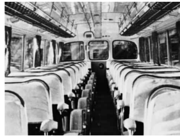
床面が平らで張り出し部分がないため、より多くのシートが配置でき、大量 人員輸送に貢献した。
