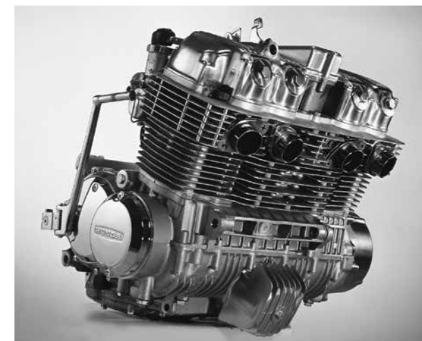
発表当時、国産最大級の排気量を誇ったCB750のエンジン。並列4気筒はホンダのGPマシンから受け継がれたメカニズムと評された。
