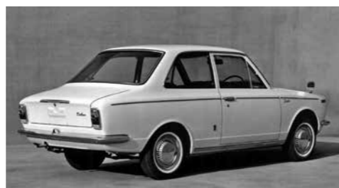
スピード感を出すためにリアウィンドウが少し寝かされたセミファストバックスタイル。縦型テールランプの採用により、トランクは開口幅が広いだけでなく、低いところから開き実用性に優れた。
