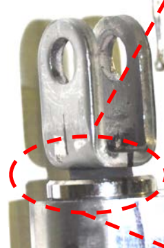
交換後のパワーシリンダ (落下事象発生時)
