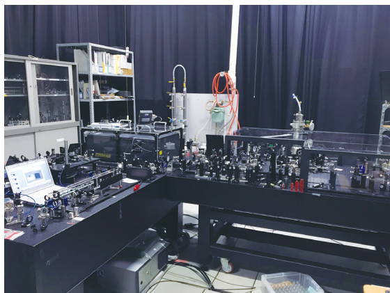
高強度テラヘルツパルス発生および位相安定中赤外パルス発生に用いるフェムト秒再生増幅パルスレーザーシステム
