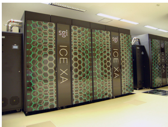
スーパーコンピュータ システム B (SGI ICE XA/UV hybrid system) The supercomputer system B (SGI ICE XA/UV hybrid system).
