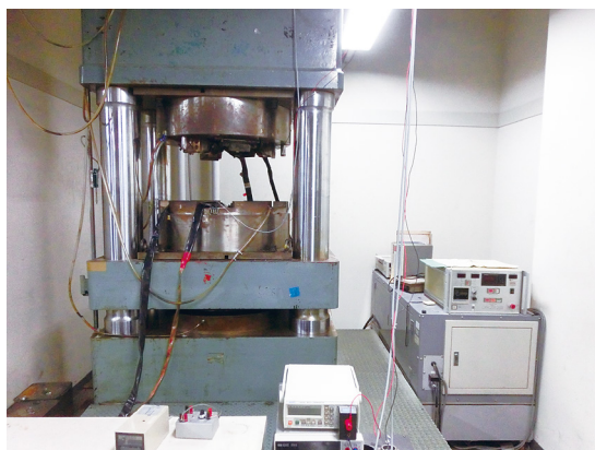
若機型 700ton キュービックプレス。4GPa までの高温高压合成実験用。
