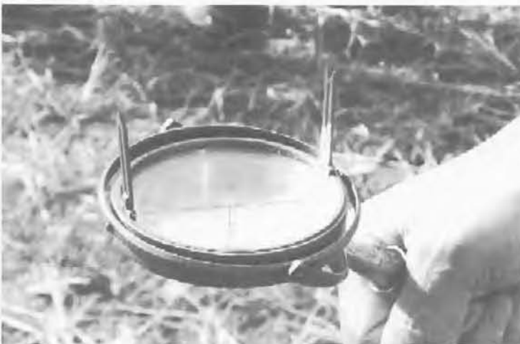
これが主役の「わんからしん」＝彎窠羅鍼 方位測定器具。小方位盤または杖先羅針などともいう。杖の先につり下げられた羅針儀で方位を測るが、傾斜地に立てたり、杖そのものが傾いても水平が保てる構造になっている。磁針の周りに三六〇度の目盛りと十二支を示す目盛りが刻まれている。
