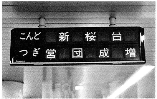
Fig. 6 液晶を用いた新型の行先表示板（銀座1丁目駅） Destination sign board using liquid crystal (Ginza 1-chome)
