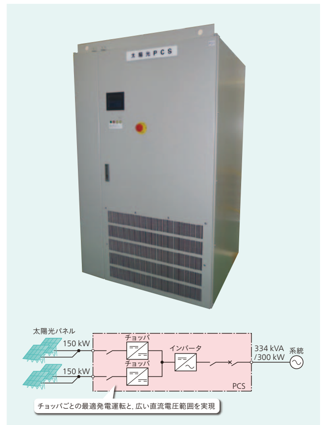
6 300 kW太陽光PCSの外観（上）、太陽光PCSの単線結線図（下）
